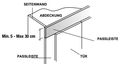
Diese werden mit Bohrlöchern geliefert und ermöglichen dadurch eine rasche Montage.
