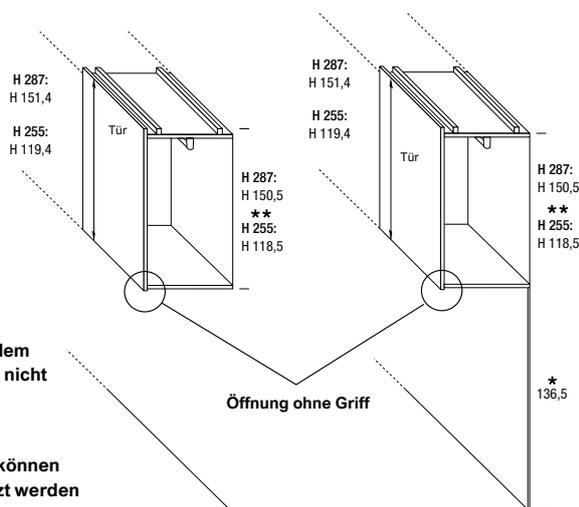
\* Die Rückwände unter dem Brückenmodul können nicht gekürzt werden
