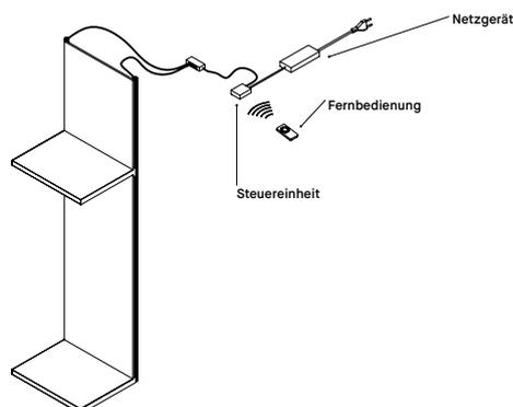
Beispiel für die Verwendung von Steuereinheiten /
