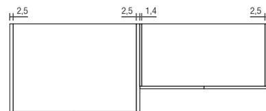
Für einen Tiefenwechsel im Falle eines angebauten Moduls ist eine Ausgleichs-Trennwand St. 1,4 erhältlich.
